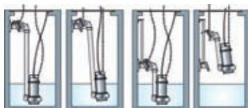
En las instalaciones en que se requiera fijar el DAC-E lejos de la tapa del sumidero, se podrá recurrir al uso de dos tubos guía (de 3/4"), útiles para acompañar la electrobomba hasta obtener su correcto acoplamiento.
