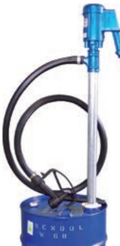
La bomba se suministra con manguera de 2 metros equipada con pistola de vaciado de alto rendimiento y gran comodidad, así como una tuerca de sujeción a bidones standard de 2" GAS.
